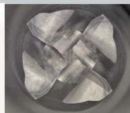
Usura dopo 50 procedimenti di penetrazione in rampa
