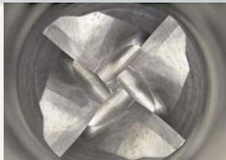
Usura dopo 80 procedimenti di penetrazione tramite Helix
